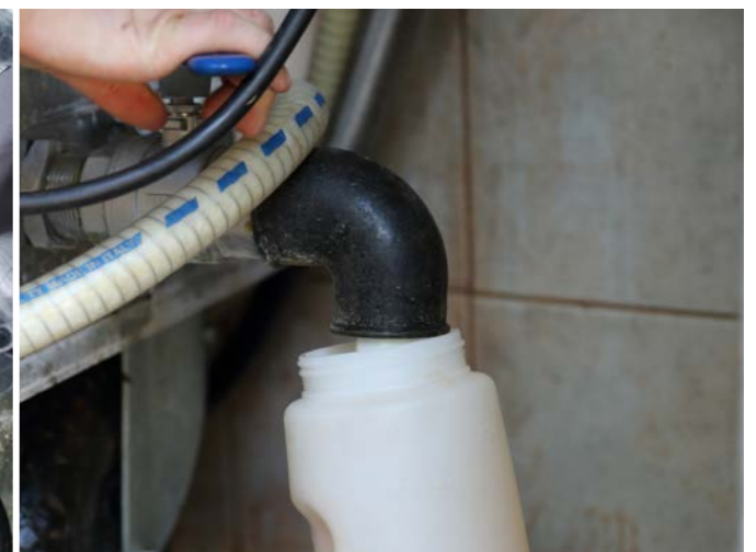
Mittels Kugelhahn lassen Sie die Milch zum Tränken der kleinsten Kälber oder das Reinigungswasser einfach ab.
